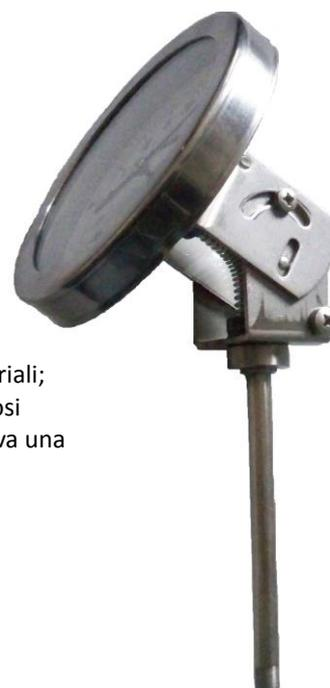
I termometri TEC 3142 e TEC 3143 trovano largo utilizzo in tutte le applicazioni industriali; poiché realizzati completamente in acciaio inossidabile sono adatti per impieghi gravosi con sostanze corrosive. Sono costituiti da un tubo in acciaio inox dentro il quale si trova una spirale elicoidale bimetallica che si deforma in seguito alle variazioni di temperatura. La versione con gambo a snodo permette l'orientamento del quadrante per una più facile lettura della misura.
