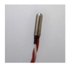
Grazie alle sue piccole dimensioni e alla sua elevata precisione questa sonda trova largo impiego in tutte quelle applicazioni dove è richiesta precisione, affidabilità e praticità. La sonda è rivestita con una guina in acciaio inossidabile AISI316 di diametro 3 mm e lunghezza 10 mm con giunto sigillato con termoretraibili in PFA. Viene fornita di connettore a spina tripolare per il rapido innesto su pannelli con prese Lemo tripolari.
